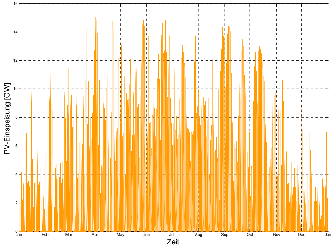
Abbildung 8: Simulierte PV-Einspeisung nach dem Szenario „Energie 2.0“ für 2020
