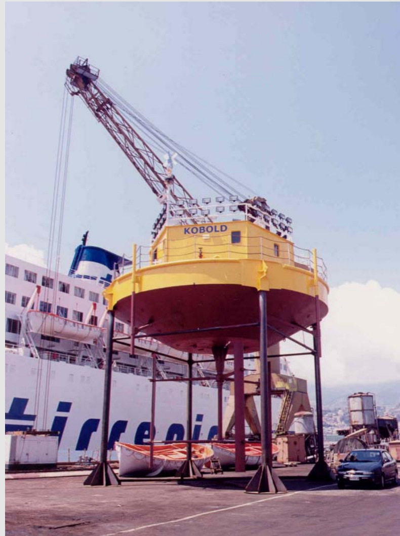
60 kW Pilot system 6 m Durchmesser, 5 m hoch
